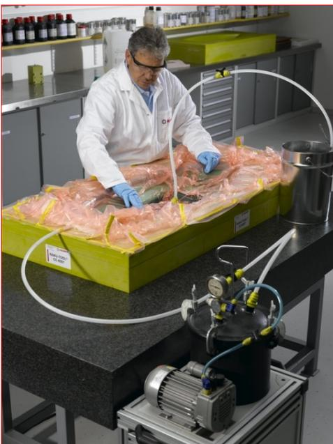
Beim RI-Fertigungsverfahren wird das Faserverbundpaket trocken in die Form eingelegt. Anschließend werden Abreißgewebe, Fließhilfen, Harz- und Vakuumkanäle platziert und die Vakuumfolie abgedichtet. Nachdem der Aufbau unter konstantes Vakuum gesetzt wurde, wird das Epoxid-Infusion-System durch den bestehenden Druckunterschied injiziert und das Faserverbundpaket imprägniert.
