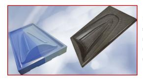
RAKU® TOOL WB-0890 besitzt eine extrem feine Oberflächenstruktur, was sowohl den Finish-Aufwand als auch den Versieglerverbrauch deutlich reduziert. Die Oberflächengüte kann vom Urmodell auf die Prepreg-Form übertragen werden, sodass kein Nachschleifen der Form erforderlich ist und die Standzeiten der Prepreg-Formen signifikant erhöht werden.
