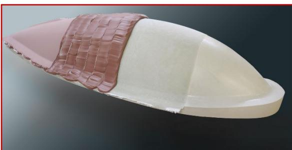
Verkleidung einer Antennenanlage, hergestellt aus dem Polyurethanschaum RAKU<sup>®</sup> TOOL SB-0096 als kostengünstiger Stützstruktur, einer zweilagigen Glasfaser-Oberflächenverstärkung und der Close Contour Paste RAKU<sup>®</sup> TOOL CP-6070/72. Adam Gourley von WildFactory, einem renommierten Modell-
