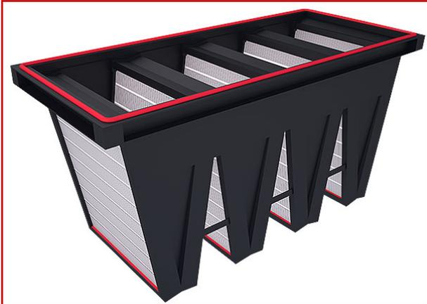
Kompakte Vergussysteme harze werden zur Befestigung von Filterelementen (zum Beispiel Endkappen) im Filterrahmen verwendet. Die silikonfreien Systeme weisen eine hohe mechanische Festigkeit, gute Fließeigenschaften und hervorragende Hafteigenschaften auf. Durch die gute Haftung auf Kunststoffen, insbesondere ABS und PS, können die Verbindungsstege der Filter als Stützelement verwendet werden. Dadurch wird die Stabilität der Filterelemente erhöht.
