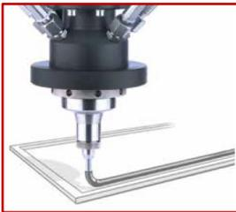
Mit leistungsstarker Dosiertechnik und robotergestützten Automatisierungslösungen werden Dichtungsraupen aus Polyurethan und Silikon auf verschiedenste Bauteile appliziert. Die Elastomere können auf ebene und gekrümmte Flächen aufgetragen werden. Nach dem Aushärten haftet eine nicht abtrennbare, elastische Dichtung (Formed In Place Gasket, FIPG) auf dem Bauteil und dichtet statisch gegen
