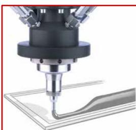
Auf hochmodernen Anlagen werden mehrkomponentige reaktive Polyurethan- und Silikonschäume zu Dichtungen verarbeitet und appliziert. Diese werden vollautomatisiert mit mehrachsigen Robotern auf ebene und gekrümmte Flächen aufgetragen. Nach der Aushärtung haftet auf dem Bauteil eine stoßfreie Dichtung (Formed In Place Foam Gasket, FIPFG), die statisch gegen Staub und Feuchtigkeit abdichtet. Die Schäume können auch in eine Trägerform dosiert und als passgenaue,
