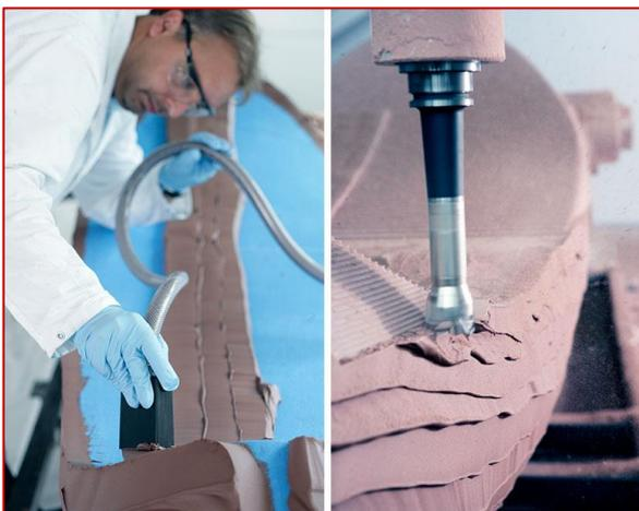
Die thixotropen, zweikomponentigen Epoxidsysteme werden mit einer Misch- und Dosiermaschine auf einen konturnahen Unterbau aufgetragen, ausgehärtet und anschließend nach CAD-Daten des Kunden CNC-bearbeitet. Hier kann nahezu jede Art von Unterbau verwendet werden, unter anderem RAKU<sup>®</sup> TOOL SB-0080 Styling-Blockmaterial, EPS und Aluminiumguss.
