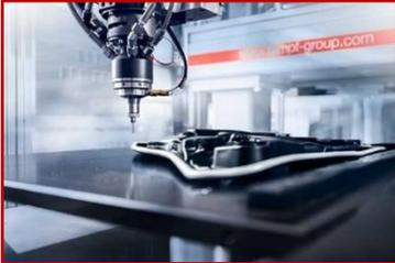
Flüssige bis hochthixotrope sowie kompakte Dichtungen auf Basis von Polyurethan (RAKU<sup>®</sup> PUR) und Silikon (RAKU<sup>®</sup> SIL) gehören ebenfalls zum Portfolio von RAMPF Advanced Polymers auf dem indischen Markt. Die leistungsstarken Dichtsysteme schützen maximal und dauerhaft vor Feuchtigkeit, Staub und chemischen Einflüssen. Zu den Applikationen gehören Batterieabdeckungen, Brems- und Rückleuchten, Ladegeräte, Lautsprecher, Sicherungskästen und Türmodule.
