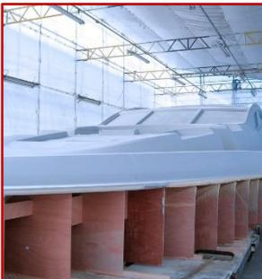
Die innovativen Zweikomponenten-Epoxid-Systeme werden mit Misch- und Dosieranlagen verarbeitet und entweder händisch oder mit einer CNC-Maschine auf einen konturnahen Unterbau aufgetragen. Dabei können nahezu alle Arten von Unterbauten eingesetzt werden, unter anderem das RAKU<sup>®</sup> TOOL Styling-Blockmaterial SB-0080 sowie EPS. Nach einer kurzen Aushärtung bei Raumtemperatur erfolgt das Fräsen nach CAD-Daten.
