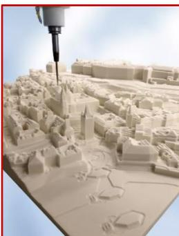
Die Halbzeuge – vorgefertigte rechteckige Polyurethanblöcke – können zu beliebigen Formen und in nahezu jeder Größe verklebt werden. Dafür stehen speziell abgestimmte RAKU<sup>®</sup> TOOL Klebstoffe in passender Härte und Farbe zur Verfügung. Modellbau-Blockmaterialien lassen sich einfach und effizient mit CNC-Maschinen fräsen; einige Platten sind auch für die manuelle Bearbeitung geeignet.
