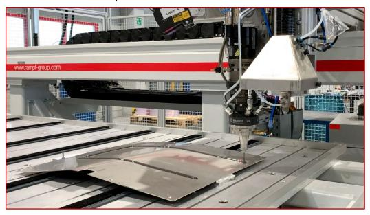
Selbst auf einer unlackierten Hochglanzoberfläche stellt der Auftrag des zweikomponentigen Polyurethan-Dichtungsschaums kein Problem dar. Zusätzlich zum 2K-Mischkopf (mit Abstandsregelung) ist die Anlage mit einer vollautomatischen Primerauftragsdüse inklusive Absaugung ausgestattet.
